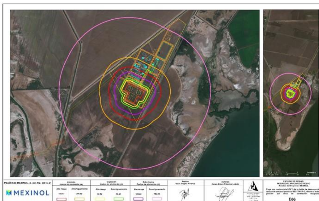
Figura 33. Escenario E06. Fuga por ruptura total (36") de la brida de descarga del tanque de metanol producto 9531T001A-C
