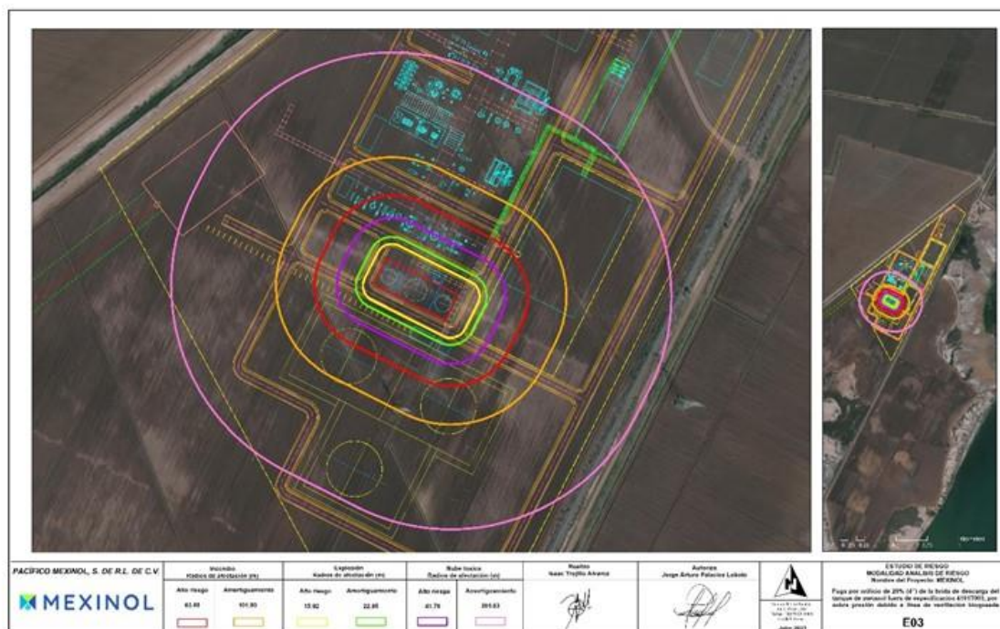
Figura 30. Escenario E03. Fuga por orificio de 20% (4") de la brida de descarga del tanque de metanol fuera de especificación 4101T003
