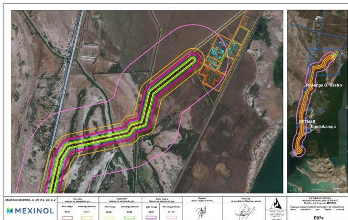
Figura 34. Escenario E07. Fuga por ruptura total del ducto (28") de metanol (1 de 4)
